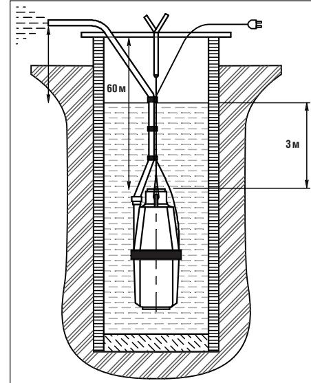
Для обеспечения свободной вибрации насоса, при высоте подвеса менее 5 метров осуществляйте подвеску на перекладину через эластичную проставку (резиновую полосу, шланг и т.д.).
