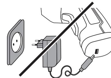
Во избежание повреждений и травм используйте зарядное устройство только для зарядки аккумулятора электроинструмента, в комплект поставки которого он входит.
