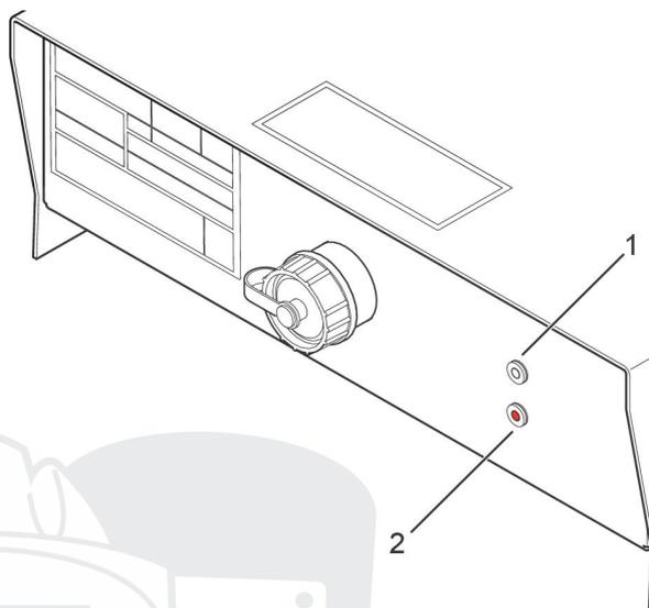
Красный светодиодный сигнализирует о ошибках в формате азбуки Морзе. Коды неисправностей перечислены ниже.
